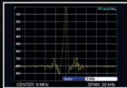
Filtercharakteristik des Roofing Quarzfilter (300 Hz)
