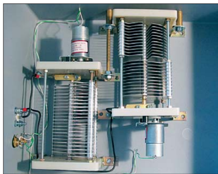
Bild 3: Fertig aufgebauter und verdrahteter Abstimmkasten
