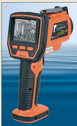
Die IR Thermo Cam misst Temperaturen von -50 °C bis 1000 °C präzise und berührungslos.
