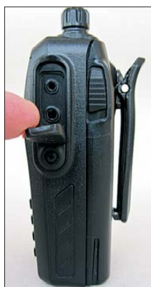
Unter der Sendtaste liegen zwei weitere Multifunktionstasten zum Auslösen des Ruf-tons, für die Taschenlampen-funktion oder den Radioempfang.
