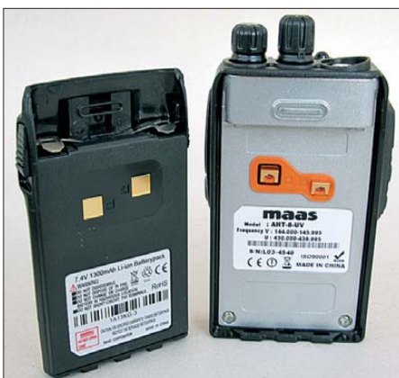
Der Lilon-Akkumulator bildet die Rückseite des Geräts.
