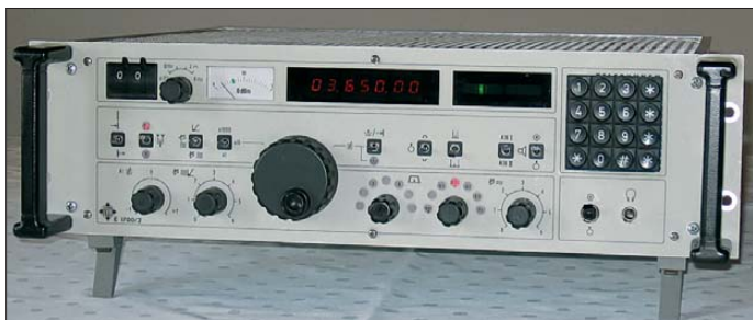
Bild 1: Eigenbauempfänger RX 96-11; die Frontplatte entstammt einem E-1700 (mit Tastatur modifiziert).
