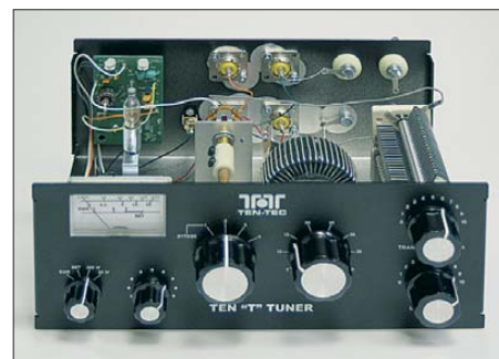
Bild 6: Antennenkoppler mit abgenommenem Gehäusedeckel; an die Buchsen auf der Rückseite lassen sich bis zu vier Antennen anschließen. Fotos: Red. FA
