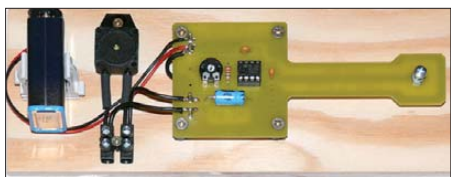
Das Bild zeigt den Aufbau der „Integrierten Morsetaste AS001“, die in den zurückliegenden 20 Jahren zahlreiche Kinder und Jugendliche begeistert hat. Mit diesem Bausatz war oftmals die erste Lötterfahrung verbunden. Foto: DH2HPH
