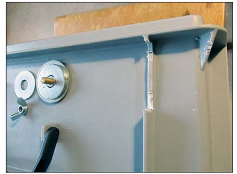
Bild 12: Auflage aus Beilagscheiben (links) und Rücknahme der Gehäuse-Verstärkungsstreben (rechts)
