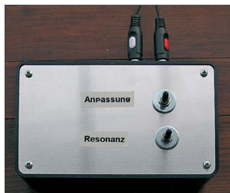
Bild 14: Bedienfeld der Fernabstimmung mit den Tastern S1 und S2
