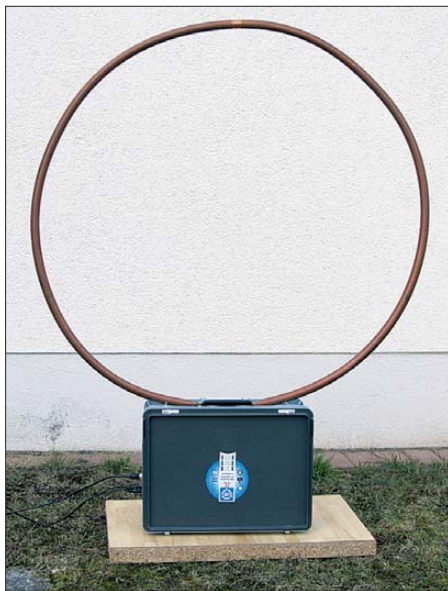
Bild 1: Frei stehender Magnetantennenring auf dem Abstimmkasten
