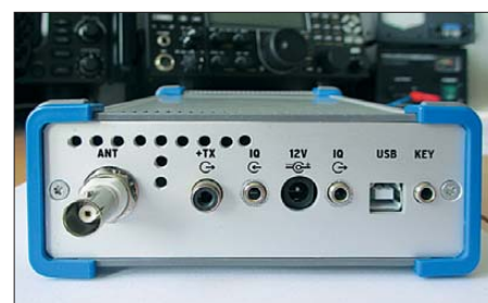
Bild 5: Rückwand des FA-SDR-Transceivers mit Lüftungsbohrungen
