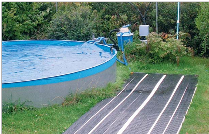
Bild 1: Versuchsaufbau mit einem hier noch auf dem Rasen liegenden Solarkollektor; im Hintergrund befinden sich Pumpe, Ventil, Filter und die Steuerung.
