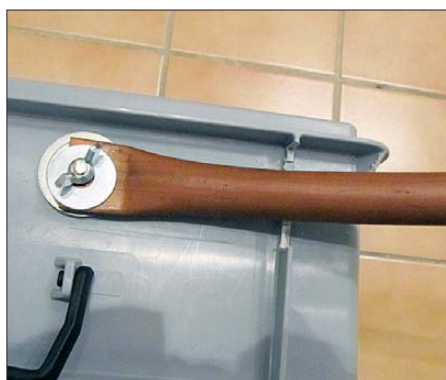
Bild 15: Befestigung des Senderahmens am Kunststoffgehäuse Fotos: DL6RAL
