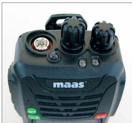
Die Antennenbuchse liegt im Gehäuse ver-senkt.
