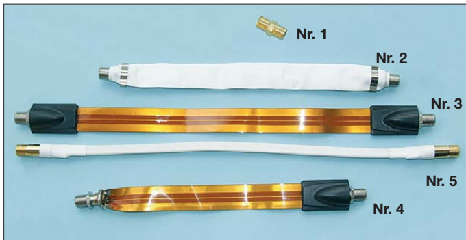
Bild 1: Ansicht der drei getesteten Fensterdurchführungen und einer nachträglich gekürzten Variante sowie der als Referenzobjekt dienenden F-Kupplung
