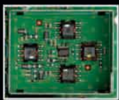
HF Verstärker mit dem großzügig dimensionierten Breitbandüberträger
